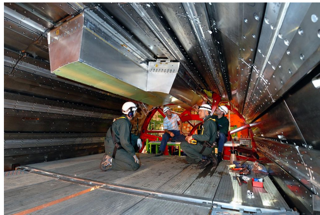
Abbildung 103: Einbau des zweiten EM-Kalorimeter-Moduls in den CMS-Detektor [cds]
