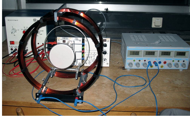
Abbildung 73: Braun'sche Röhre: Versuchsaufbau zur schwachen Fokussierung
