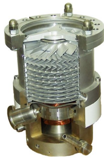
Abbildung 52: Schnitt durch eine Turbomolekularpumpe [Wik08b]
