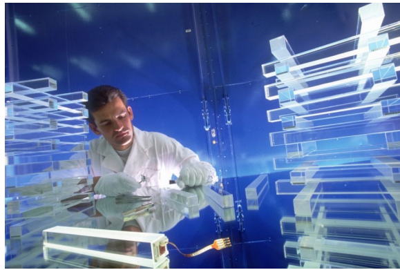
Abbildung 102: Verkabelung der Kristalle des EM-Kalorimeters [cds]
