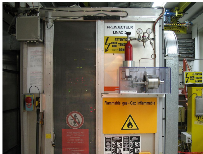
Abbildung 45: LHC Duoplasmatron-Protonenquelle im Faradaykäfig
